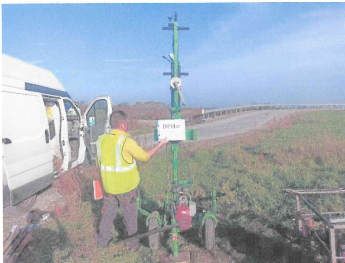
Fig. 27. Penetrare dinamică DPH02 – F12
