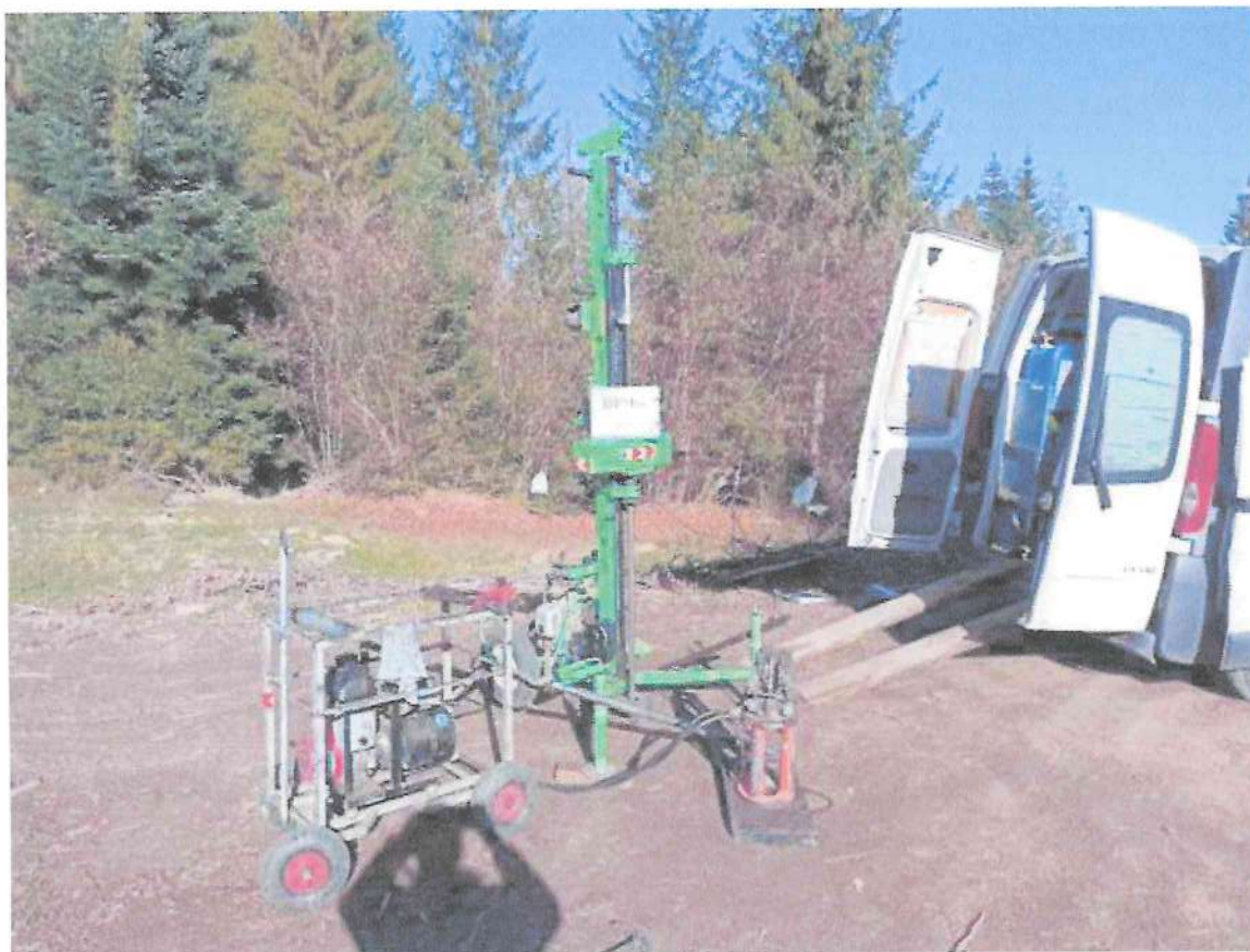
Fig. 26. Penetrare dinamică DPH01 – F11
